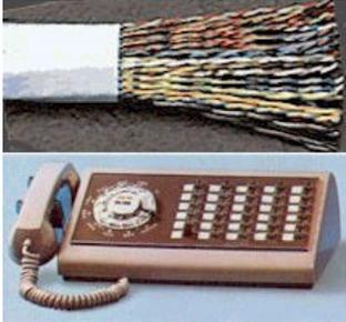
comenzaron a difundirse en la década de 1920, consistían en conectar varias líneas urbanas a distintos botones o teclas de un mismo teléfono. Cada teléfono era conectado con varios cables (por lo menos un por cada línea telefónica, pero se requerían otros varios para controles, encendido de luces, etc.) hasta una caja central, dónde se realizaban todas las conexiones y empalmes
